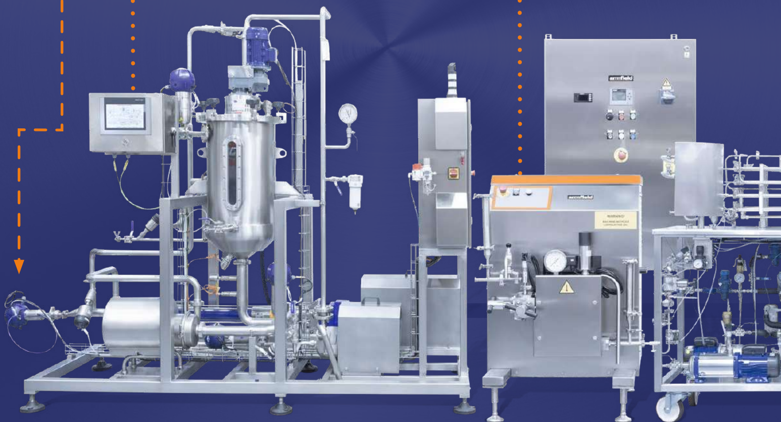
Desgasificación continua y en lote
