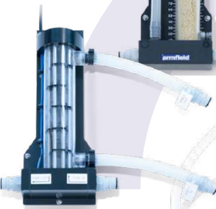
FS-3.1: intercambiador de calor de carcasa y tubos
