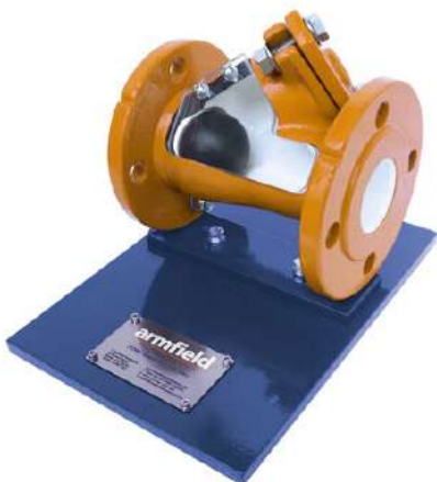
ME30: Válvula esférica de retención seccionada
