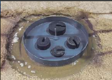
Socavación alrededor de un pilar circular de un puente
