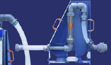
C9-MKII-9: Flujómetro de área variable con transductor
